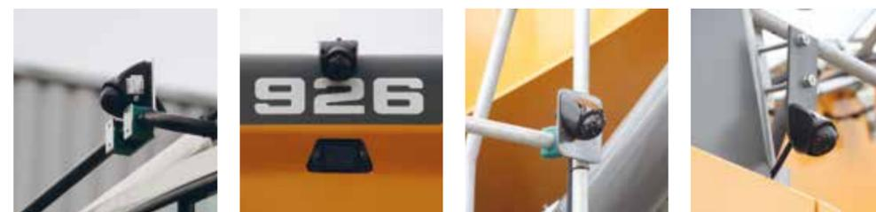
Um einen nahtlosen Rundumblick zu generieren werden vier hochwertige Kameras rundum an das Fahrzeug montiert,
